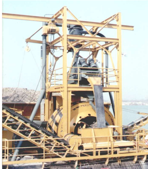
Trommel mit zusätzlicher Feinsand- Rückgewinnungs- Anlage, 400 t/h
