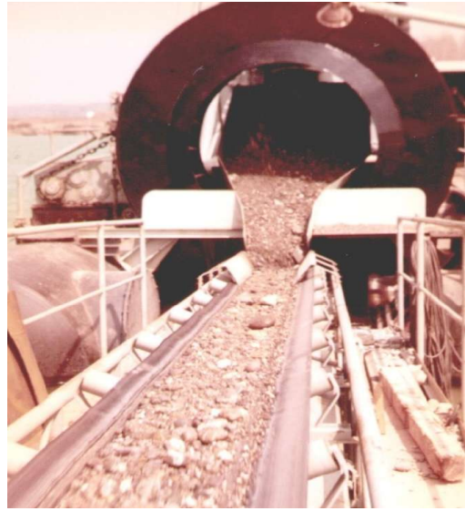
Trommel zur Kiesentwässerung 350 t/h
