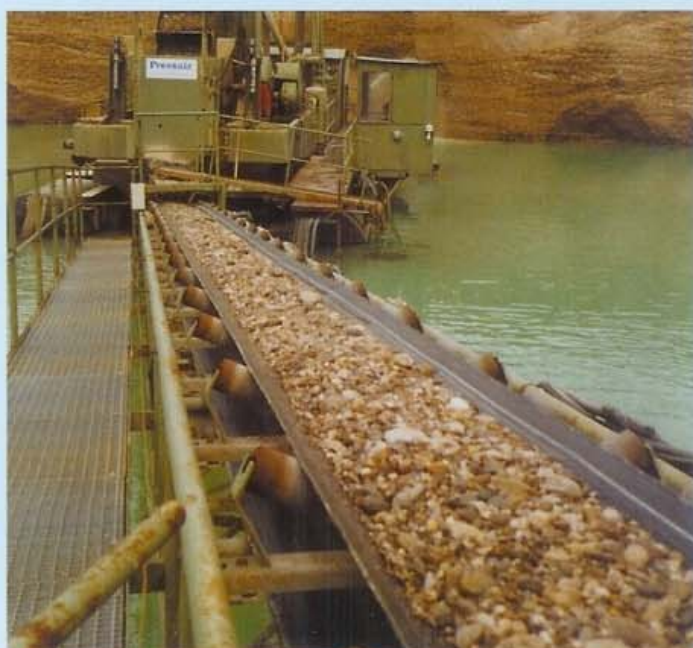
DSB 400-1 mit Entwässerungs-Trommel. 350 t/h bei 14 m Tiefe, 110 kW
