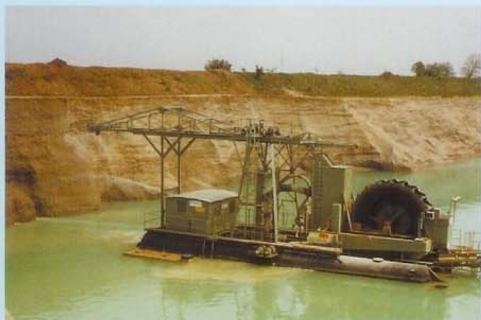
DSB 300-1 mit Entwässerungs-Schöpfrad, 275 t/h bei 14 m Tiefe, 110 kW
