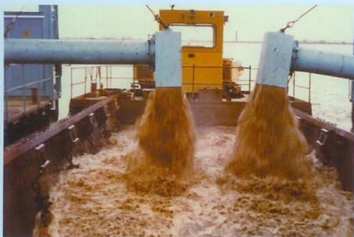
DSB 400-2 mit direkter Schutenbeladung. Hoher Feststoffanteil von 30-50%, 700 t/h bei 20 m Tiefe, 360 kW.
