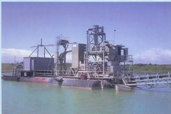
DSB 400-1 mit Entwässerungssieb und Feinsand-Rückgewinnung. 360 t/h bei 20 m Tiefe, 200 kW
