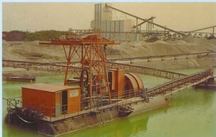
DSB 400-1 mit Entwässerungs-Trommel. 350 t/h bei 14 m Tiefe, 110 kW
